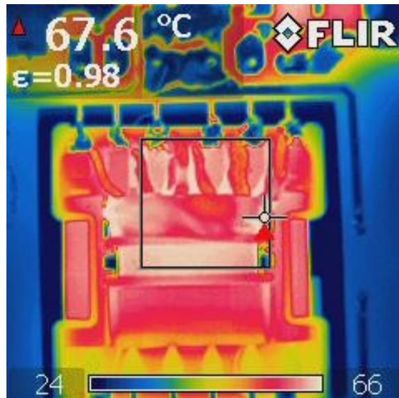
圖 34 – 變壓器 (T1)。熱跡仰視圖，滿載，室溫。
