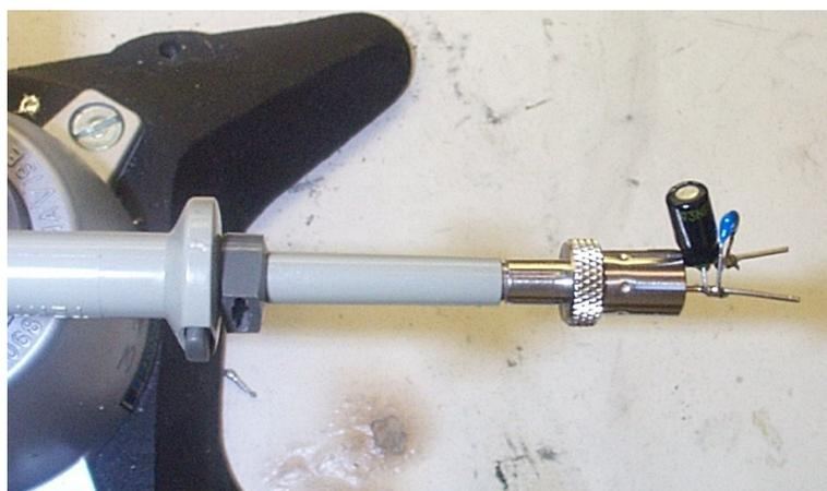
圖 25 – 使用 Probe Master ([www.probemaster.com](http://www.probemaster.com)) 4987A BNC 轉換器的示波器探棒。
