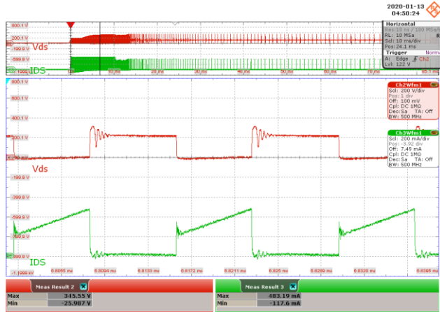
Figure 60 – 90 VAC 60 Hz. CH2: V_{DS} , 200 V / div., 10 ms / div. CH3: I_{DS} , 200 mA / div., 10 ms / div. Zoom: 3.9 \mu s / div. V_{DS(MAX)} = 345.55 V, I_{DS(MAX)} = 0.483 A.
