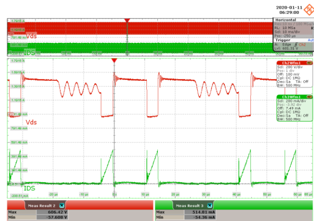
Figure 51 – 265 VAC 50 Hz. CH2: V_{DS} , 200 V / div., 10 ms / div. CH3: I_{DS} , 200 mA / div., 10 ms / div. Zoom: 10 \mu s / div. V_{DS(MAX)} = 606.42 V, I_{DS(MAX)} = 0.514 A.
