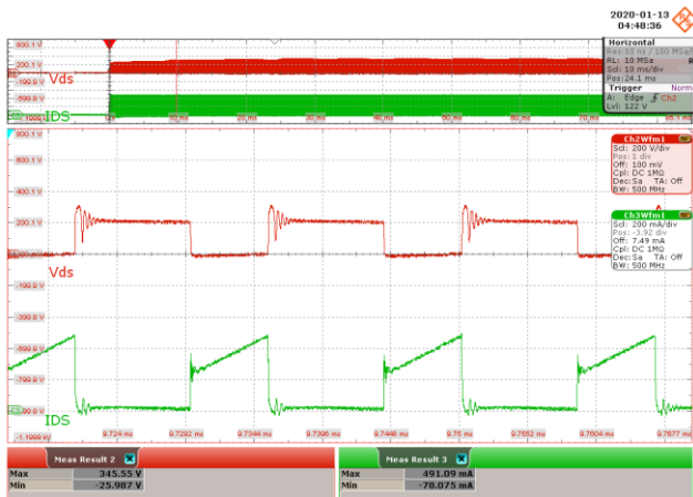
Figure 56 – 90 VAC 60 Hz. CH2: V_{DS} , 200 V / div., 10 ms / div. CH3: I_{DS} , 200 mA / div., 10 ms / div. Zoom: 5.2 \mu s / div. V_{DS(MAX)} = 345.55 V, I_{DS(MAX)} = 0.491 A.
