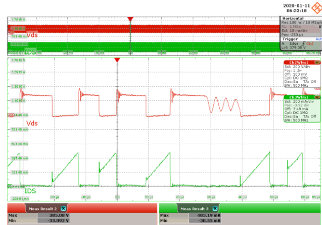
Figure 49 – 115 VAC 60 Hz. CH2: V_{DS} , 200 V / div., 10 ms / div. CH3: I_{DS} , 200 mA / div., 10 ms / div. Zoom: 10 \mu s / div. V_{DS(MAX)} = 385.08 V, I_{DS(MAX)} = 0.483 A.
